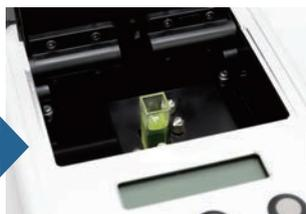
セルを装置にセットし、フタを閉めます。
