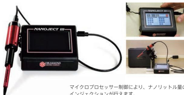
マイクロプロセッサ制御により、ナノリットル量のインジェクションが行えます。
