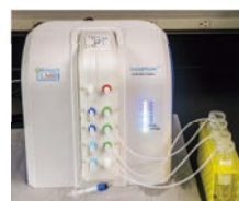
オープンカートリッジ (#C1103) 最大 2 種類のカラムと 3 種類 のバッファーを自由に組み 合わせ可能
